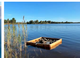
Här testas en ny plattform som är tillverkad av värmehandlat trä. Här högt den flyter kan justeras med hjälp av tyngder.
